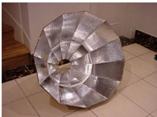
*La parabole du four vue de l'intérieur*
